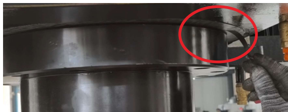
13. 在此处加入塞尺以增加矮面一端的高度 Add a height gauge here to increase the height
